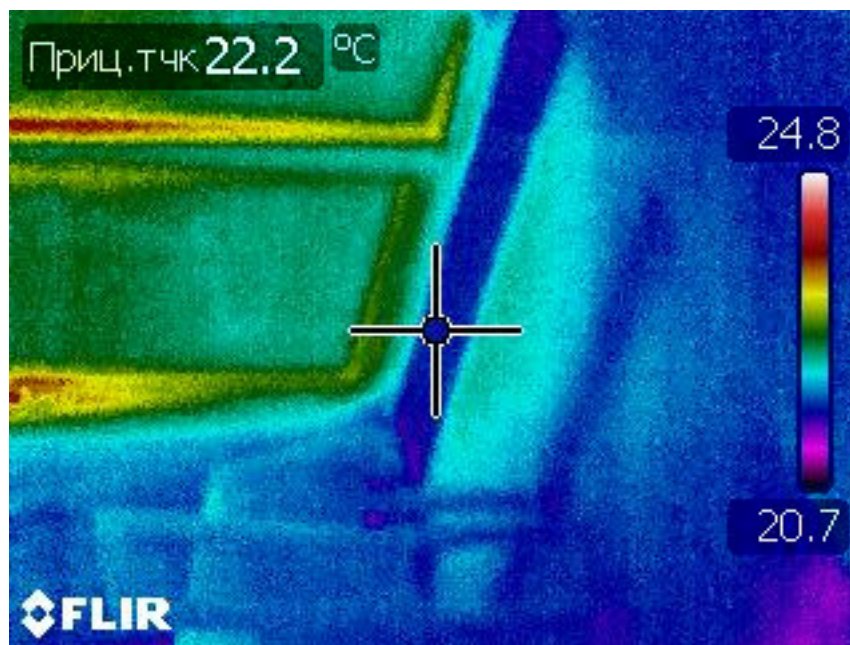
Рис. 3. Тепловой портрет стеклопакета и светового пятна на деревянном полу (изображение с поворотом на 90^\circ )
