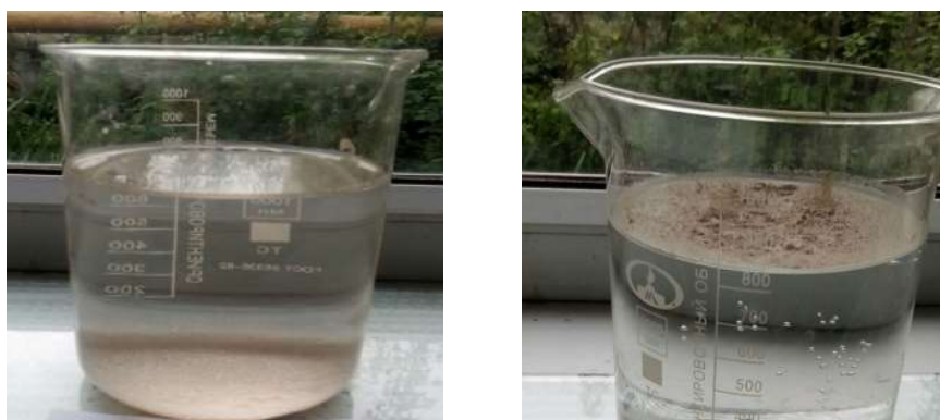
Рис. 1. Гидрофобность известнякового минерального порошка а) контрольной образец; б) после гидрофобизации
