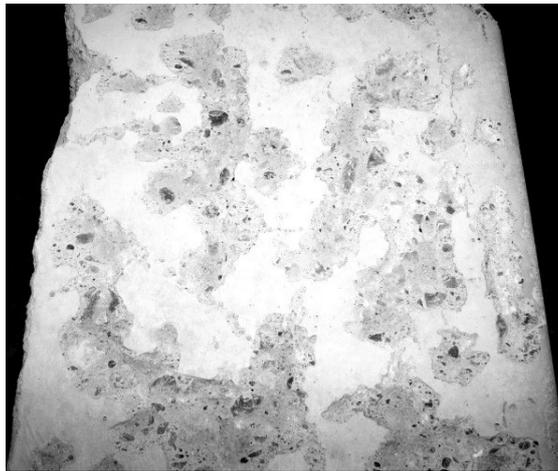
Рис. 5. Шероховатая поверхность усиленной балки
