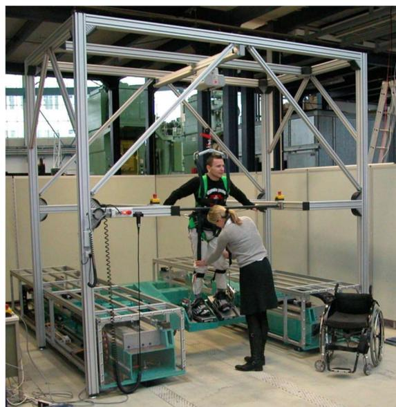
Рис. 6. Робот-симулятор ходьбы для реабилитации походки *Haptic Walker*
