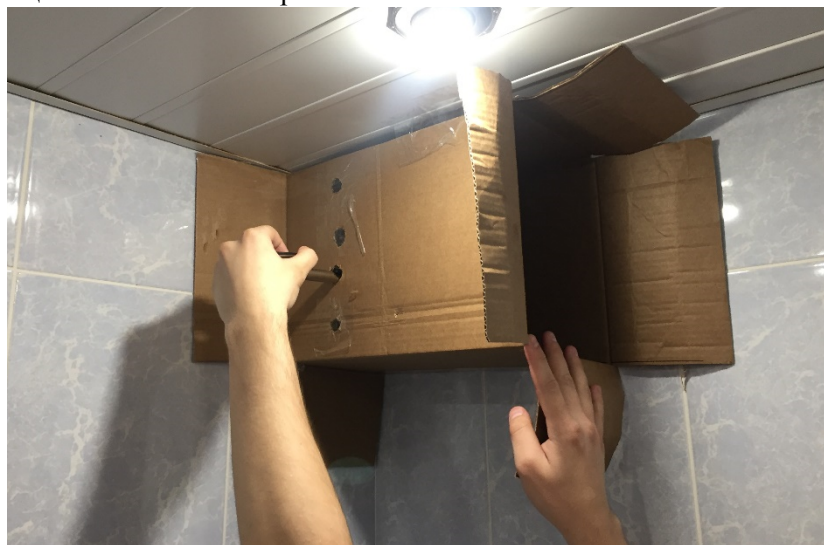
Рис. 1. Измерение расхода воздуха с помощью измерительного насадка
