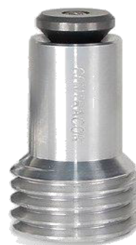
Рис. 9. Сопла для трубной очистки серии РТС 360° из карбида вольфрама, срок службы – до 400 часов, оболочка – алюминий. Резьба – 50 мм. Входной диаметр – 32 мм. Диаметр и длина сопла: 8.0×75 мм
