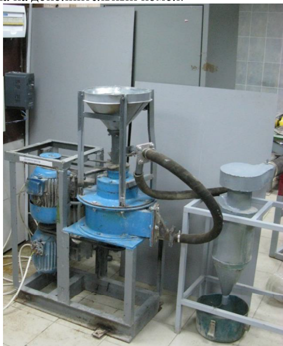
Рис. 1. Дезинтегратор с криволинейным патрубком возврата материала
