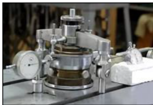
Рис. 4. Сдвиговый прибор конструкции института «Гидропроект»
