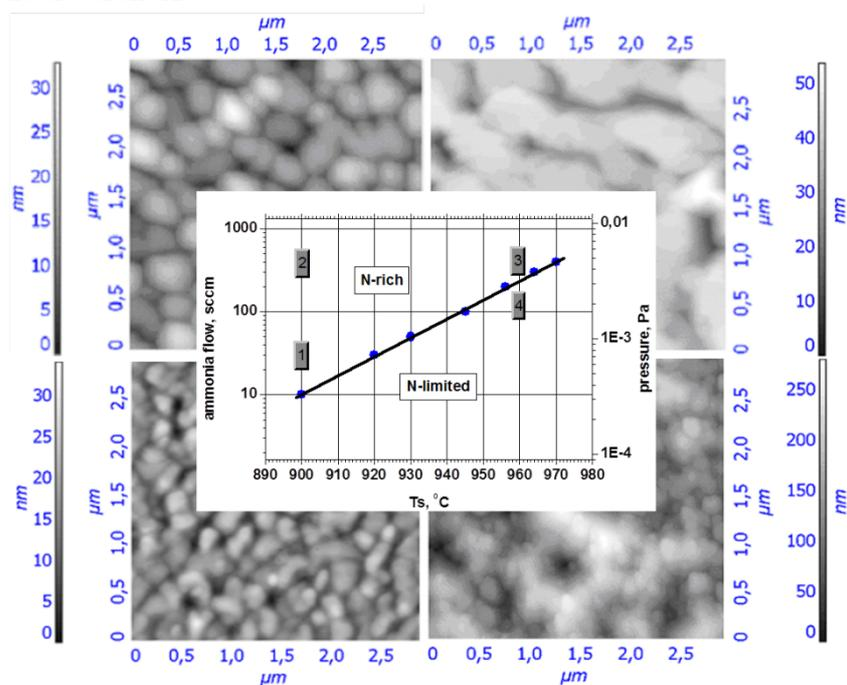
Рис. 1. Изображения поверхности слоев GaN толщиной 1 мкм, выращенных при различных температурах и потоках аммиака, полученные при помощи атомно-силовой микроскопии. На вставке показана зависимость температуры начала заметного разложения GaN во время роста от потока аммиака и характерные режимы роста
