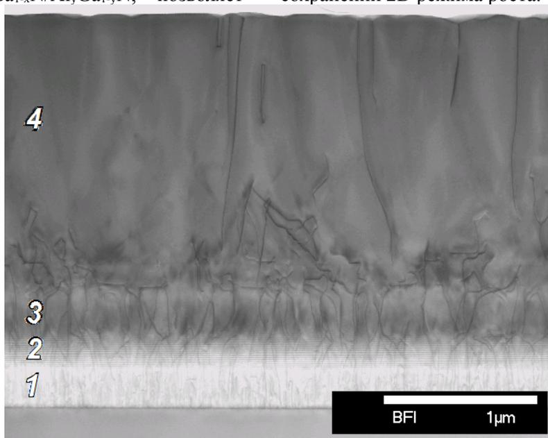
Рис. 2. Изображение скола многослойной гетероструктуры полученное с помощью STEM; указаны слои 1 – AlN; 2 – SLS; 3 – Al<sub>0.5</sub>Ga<sub>0.5</sub>N; 4 – GaN
