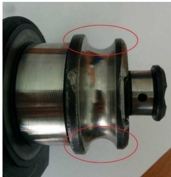
Рис. 1. Дорожка качения лапы трехшарошечного долота
