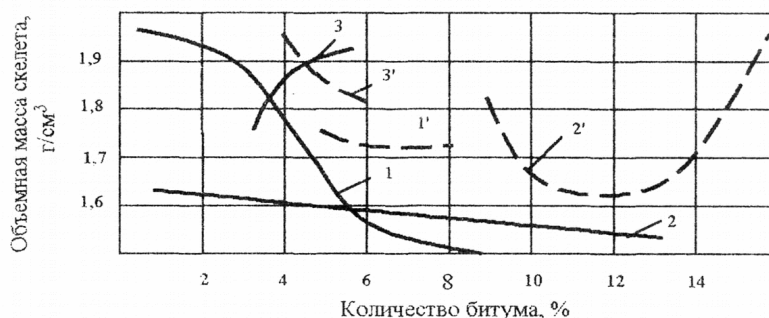
Рис. 3. Зависимость изменения объемного веса скелета от содержания битума
