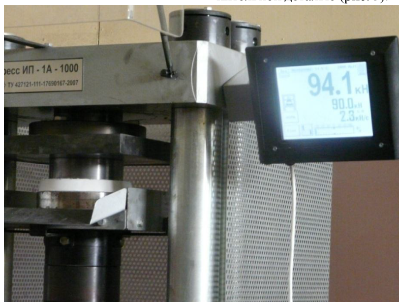
Рис. 3. Испытание раструбного сварного соединения на сдвиг сжатием на машине ИП-1А-1000
