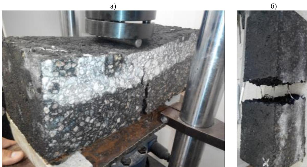
Рис. 4. Вид образца-балочки 120×120×320 мм, серия № 2:
