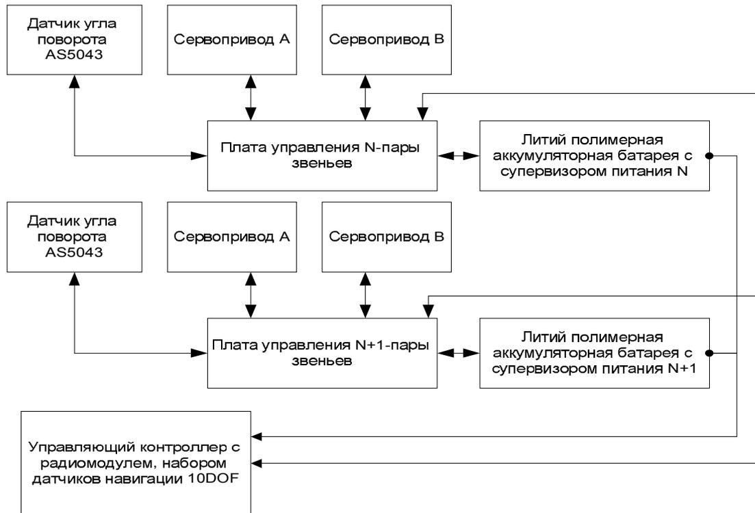
Рис. 2. Схема системы управления змееподобным роботом
