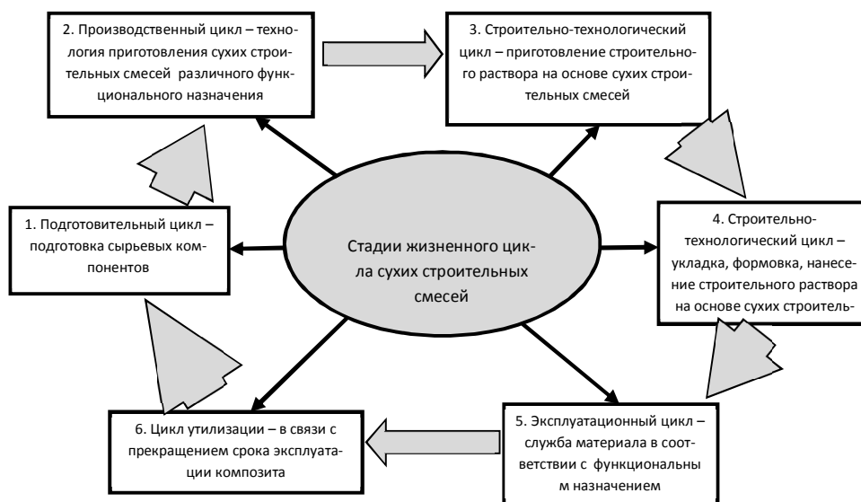
Рис. 3. Стадии жизненного цикла сухих строительных смесей
