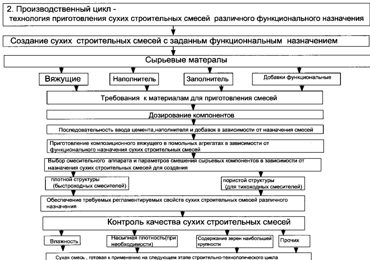
Рис. 6. Производственный цикл приготовления сухих строительных смесей
