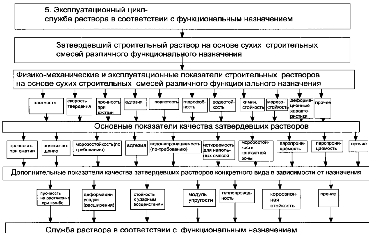
Рис. 9. Эксплуатационный цикл – служба раствора в соответствии с функциональным назначением
