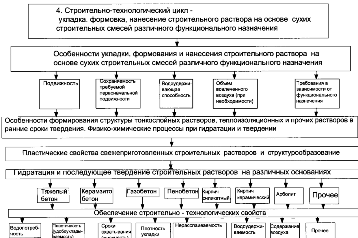
Рис. 8. Строительно-технологический цикл - укладка, формовка строительного раствора
