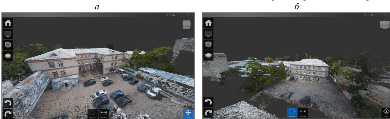
Рис. 3. Облако точек, полученное на основе съемки дроном: а – вид 1; б – вид 2
