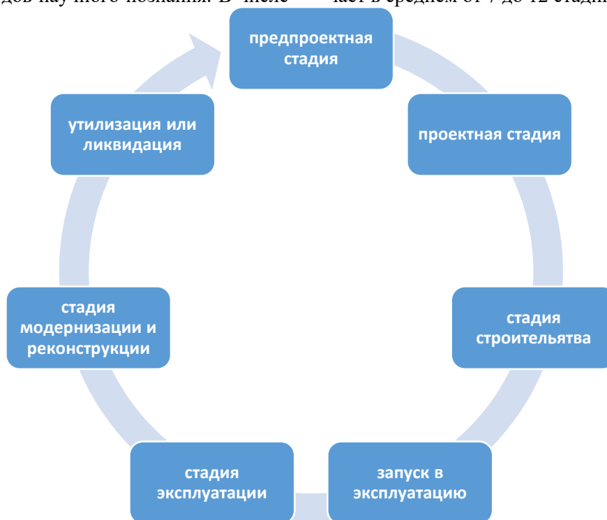
Рис. 1. Жизненный цикл объектов капитального строительства [6–7]
