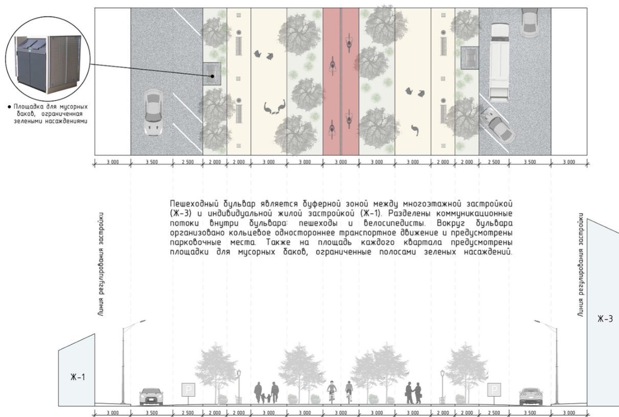
Рис. 4. Схема бульвара с разделёнными видами движения
