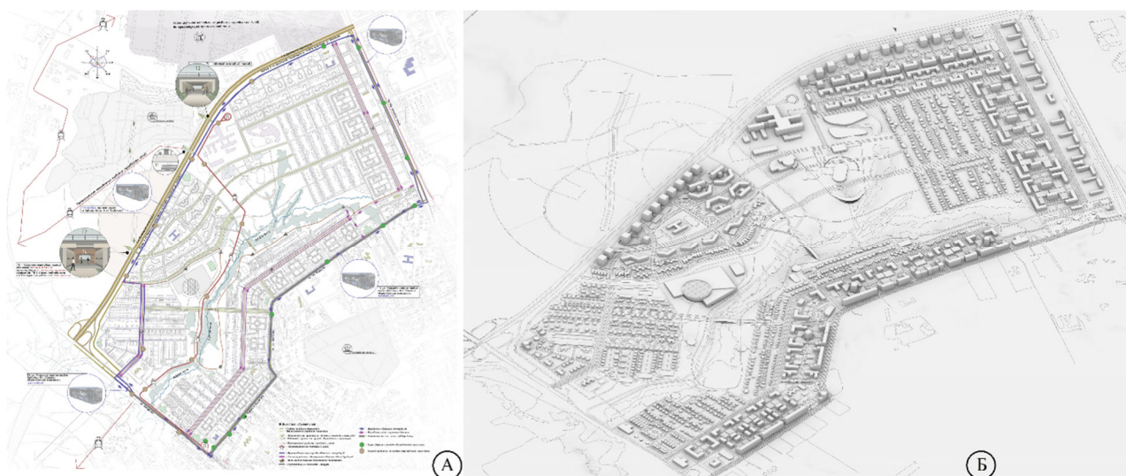
Рис. 3. Схемы реконструкции территории, прилегающей к Дубовой балке: А – схема организации транспортно-пешеходного движения; Б – визуализация продольных и поперечных связей территории
