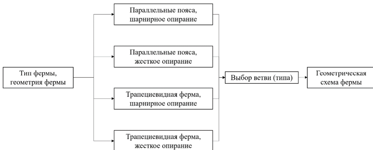
Рис. 4. Схема фрагмента скрипта генерации фермы покрытия
