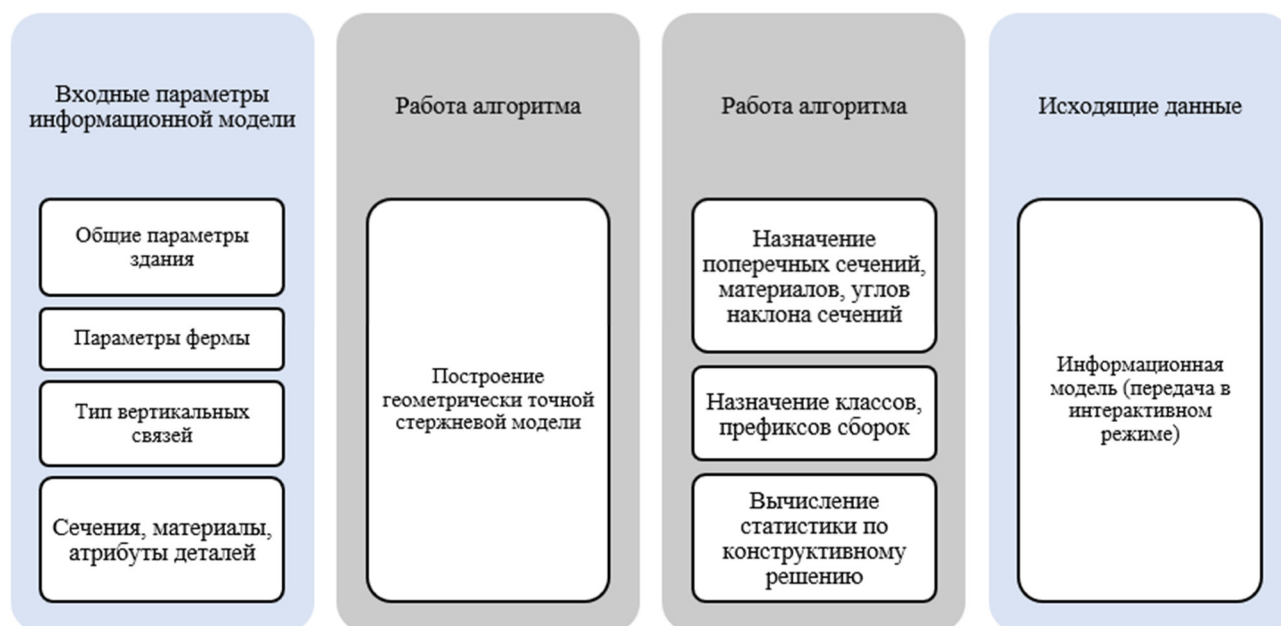
Рис. 3. Схема алгоритма формирования информационной модели
