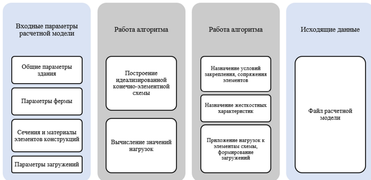
Рис. 2. Схема алгоритма формирования расчетной модели
