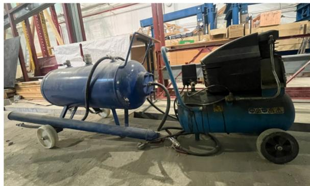
Рис. 1. Лабораторный пеногенератор с пенопатроном и компрессором
