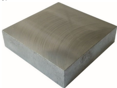
Рис. 1. Тестовая деталь для измерения отклонения от плоскостности
