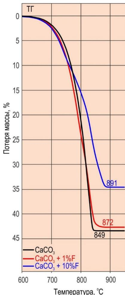
Рис. 4. Кривые потери массы процесса декарбонизации CaCO<sub>3</sub>
