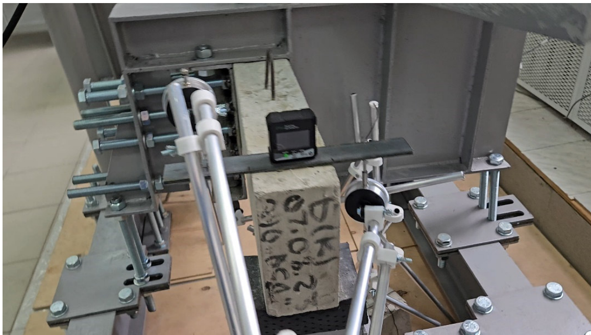
Рис. 4. Фиксация положения оголовников
