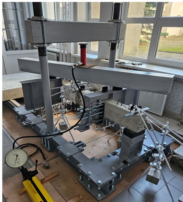
Рис. 1. Стенд для испытаний строительных конструкций на изгиб с кручением при статическом длительном и кратковременном воздействии
