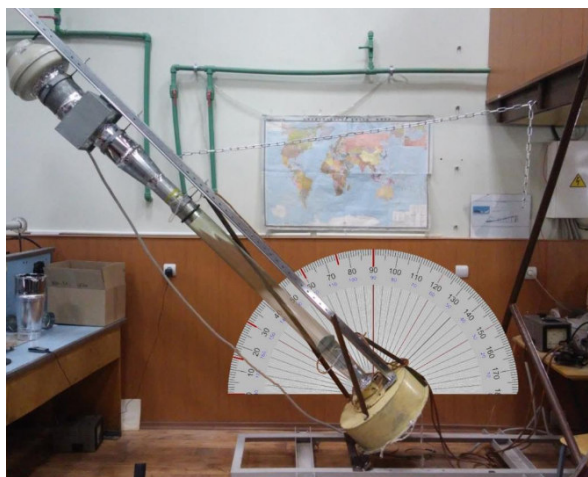
Рис. 1. Лабораторная установка для исследования скорости транспортирования:
