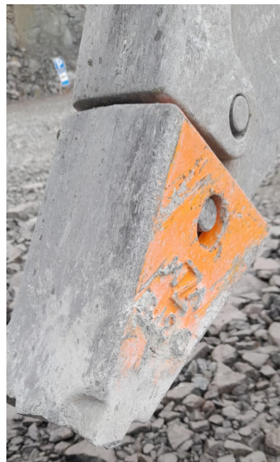
Рис. 5. Расколовшаяся посадочная часть коронки на стойке бульдозера D-375
