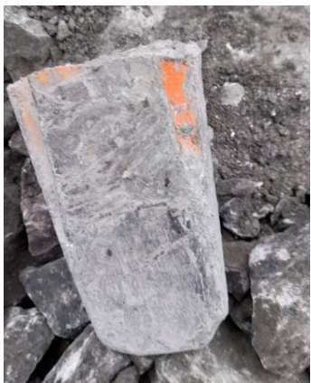
Рис. 6. Отколотая консольная часть коронки для бульдозера D-375 (ее посадочная часть показана на рисунке 5)
