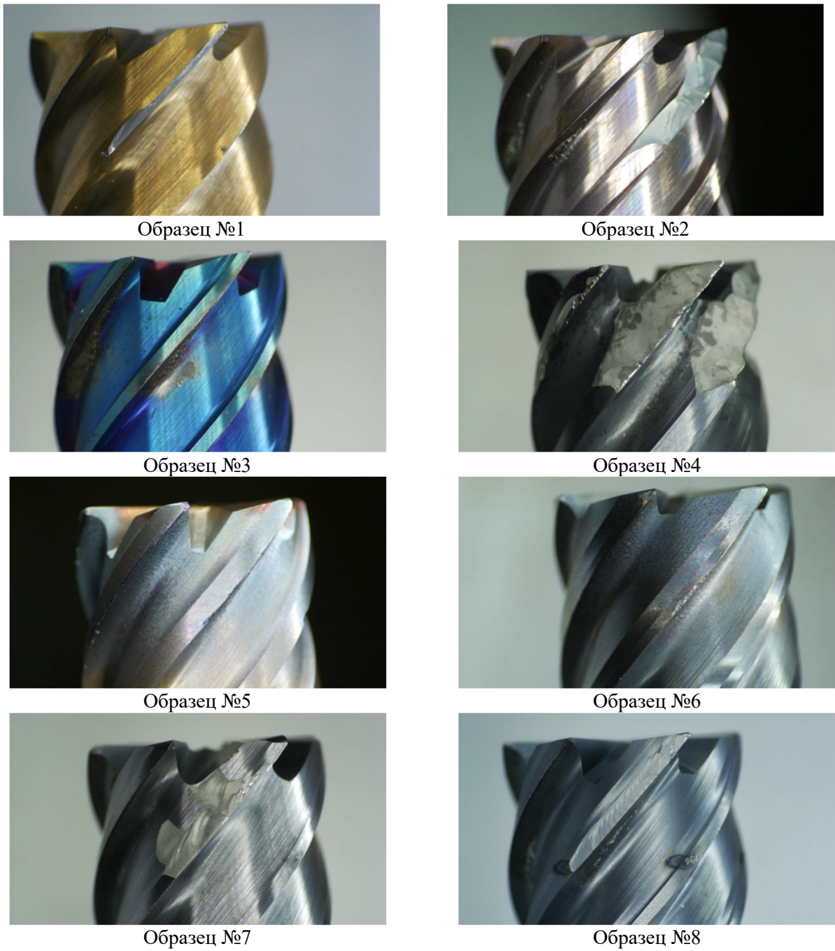
Рис. 6. Характер разрушения образцов в результате проведения эксперимента.
