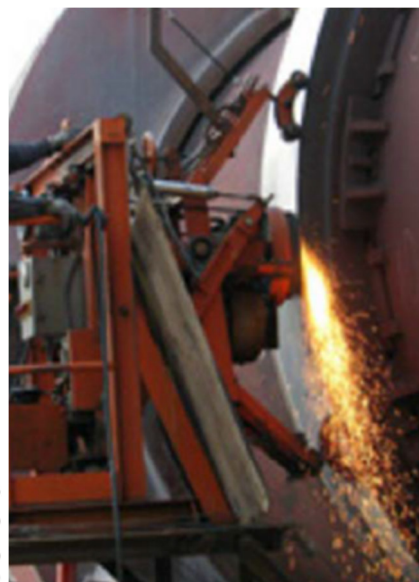
Рис. 4. Шлифовальный переносной станок компании Phillips Kiln Services LTD
