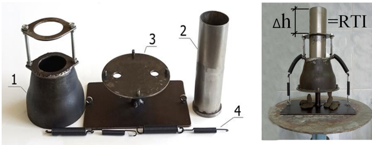
Рис. 1. Прибор для определения реологического технологического индекса смесей (ПОРТИС): 1 – конический корпус; 2 – поршень определенной массы; 3 – столик с отверстиями для выхода смеси; 4 – пружинные фиксаторы
