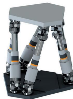
Рис. 1. Эскизный 3D вид роботизированной платформы подвижности
