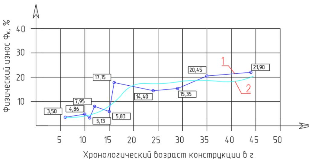
Рис. 3. Медианный физический износ подкрановых балок:
