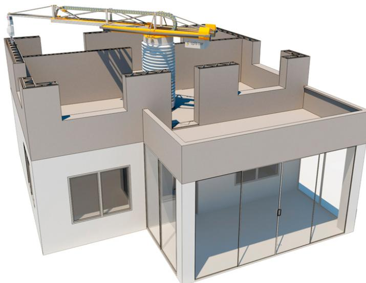
Рис. 1. Возведение зданий с применением опалубки по 3D-аддитивной технологии
