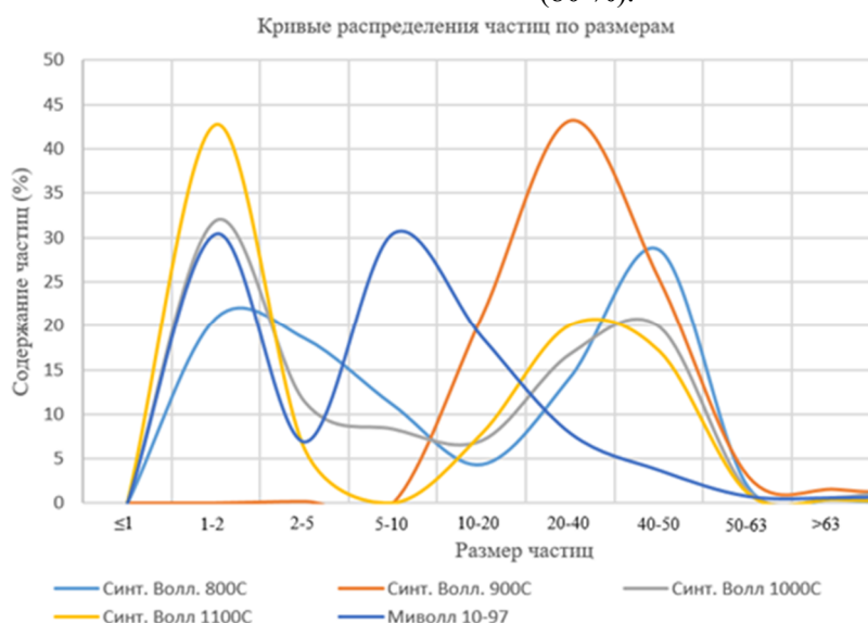
Рис. 1. Кривые распределения по размерам частиц синтетического волластонита с молярным соотношением оксида кальция и диоксида кремния 1,2:1, полученного при различных температурах, в сравнении с природным минералом
