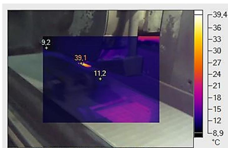
Рис. 7. Распределение температурных полей при шлифовании металлополимерного образца
