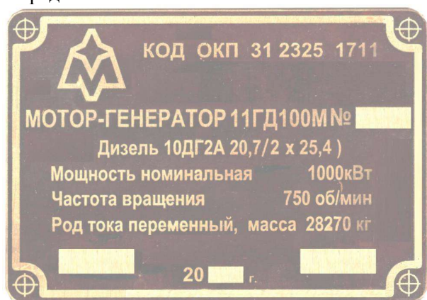
Рис. 3.б. Табличка мотор-генератора 11ГД100 М
