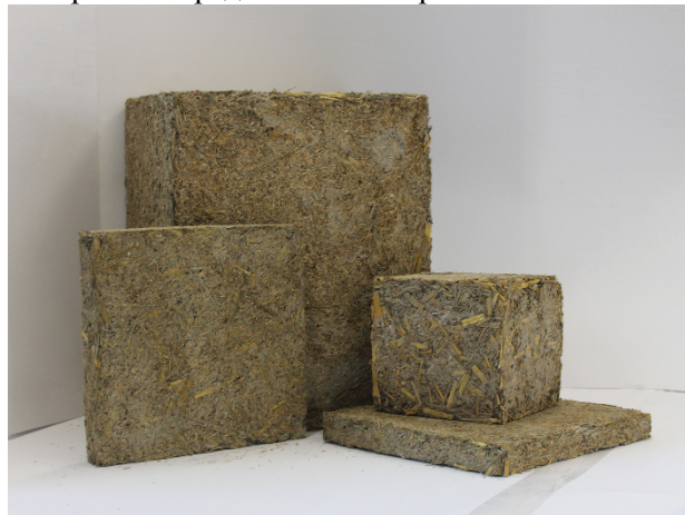
Рис. 1. Внешний вид образцов на основе смеси соломы и костры льна
