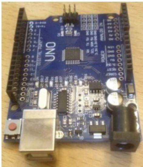
Рис. 4. Arduino UNO R3
