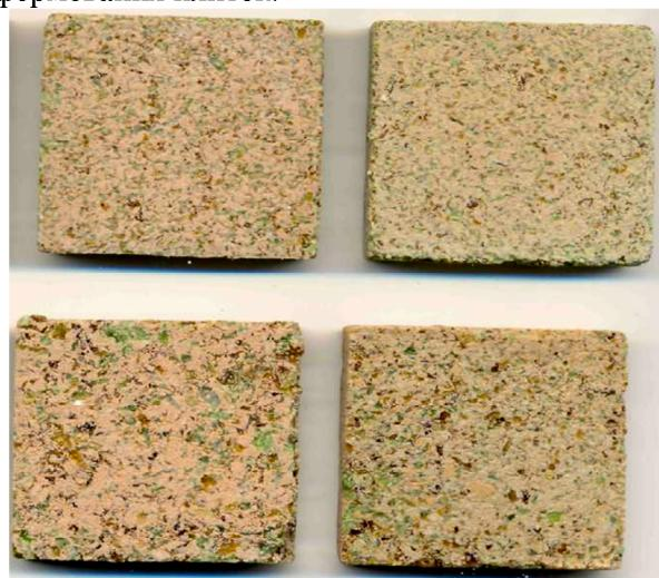
Рис. 3. Внешний вид плиток облицовочного стеклокерамического композита на основе стекольного боя
