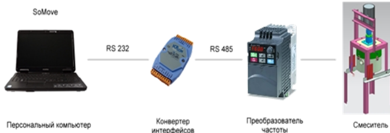
Рис. 1. Структура системы управления электроприводом смесителя
