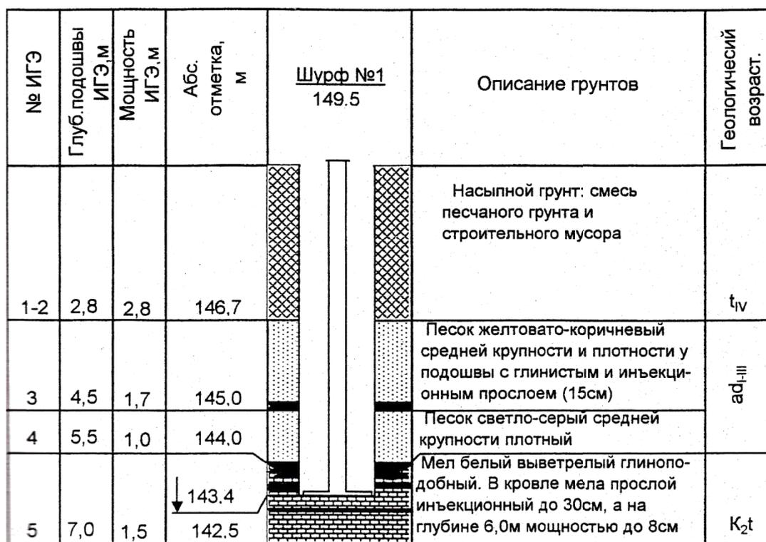
Рис. 2. Инженерно-геологический разрез
