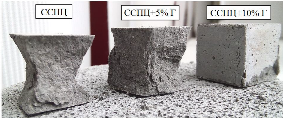
Рис. 3. Характер разрушения образцов при испытании на прессе
