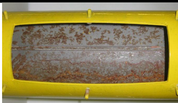
Рис. 1. Деформация корпуса верхней помольной камеры
