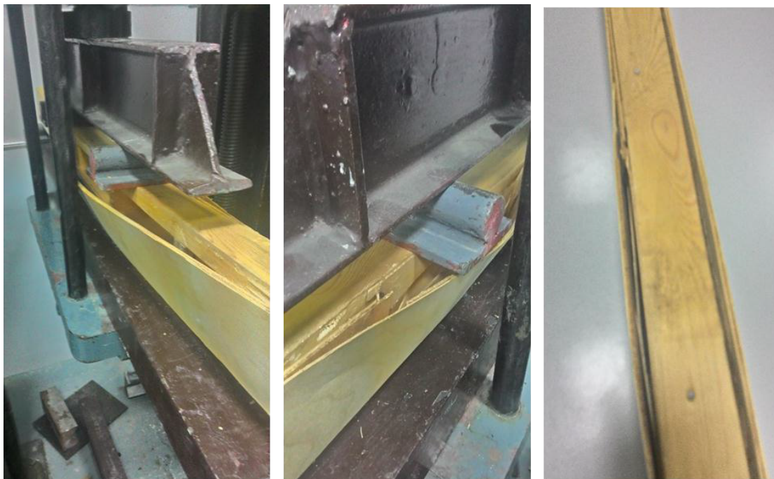
Рис. 4. Характер разрушения образца фанерной клееной балки
