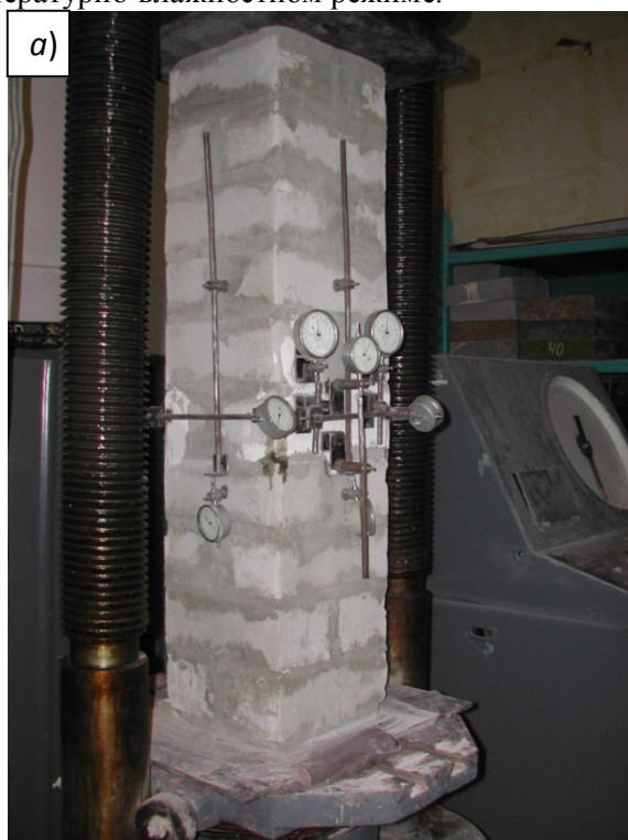
Рис. 1. Вид образца кладки из мелких пенобетонных камней до (а) и после (б) испытания на сжатие
