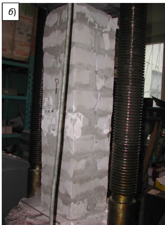
Рис. 1. Вид образца кладки из мелких пенобетонных камней до (а) и после (б) испытания на сжатие
