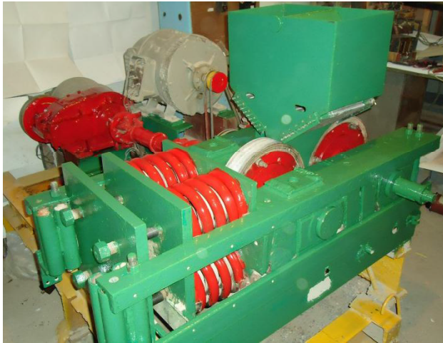
Рис. 1. ПВИ с валковым устройством: 1 – валковое устройство, 2 – ПВИ
