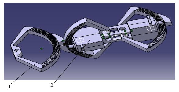
Рис. 1. Конструкция звеньев змееподобного робота
