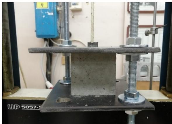
Рис. 1. Схема образца для испытания на выдергивание
