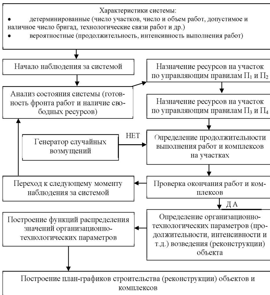
Рис. 1. Схема построения имитационной модели разработки и внедрения ППС(Р) объектов и комплексов
