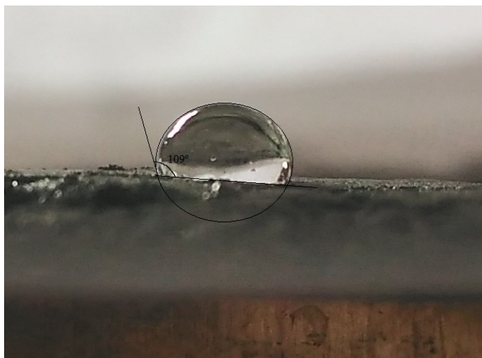
Рис. 4. Схема определения краевого угла смачиваемости модифицированного порошка гидроксида титана
