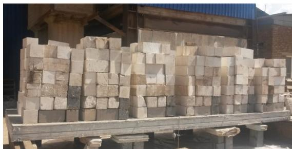
Рис. 9. Испытание опытной плиты на производственной базе «УГК»
