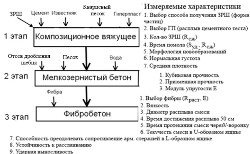
Рис. 1. План исследований композиционного вяжущего и бетонов на его основе
